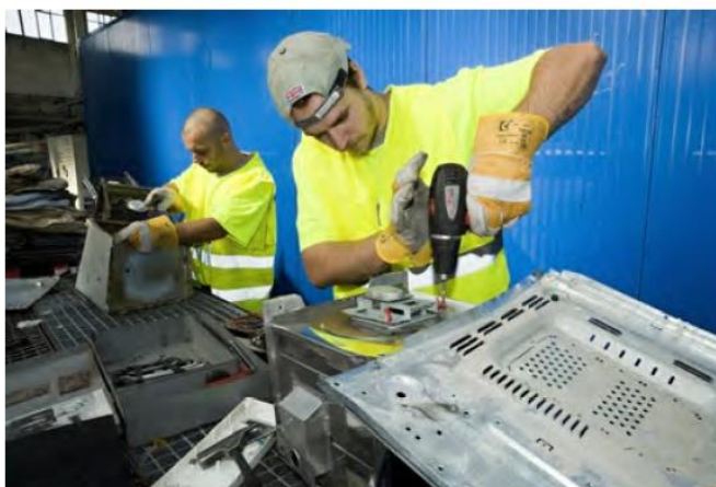
Ruční demontáž malých elektrospotřebičů.
